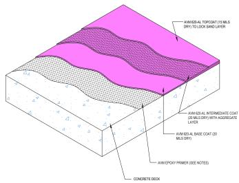
FIGURE 3.2 - 3-COAT ASSEMBLY FOR MAXIMUM SLIP RESISTANCE
